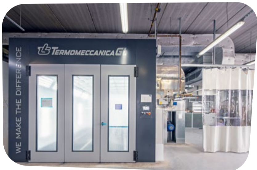
Čelní pohled na nový lakovací box Termomeccanica s rekuperační jednotkou pro významnou úsporu energie, vpravo přípravné stání oddělené od sousedních lakovacích technologií plentou.
