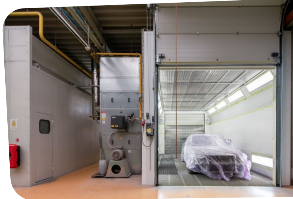
Pohled na výjezdová sekční vrata nového lakovacího boxu Wolf. Oboustranně použitá sekční vrata umožňují plynulé navedení lakovaných aut do boxů.
