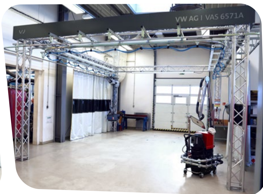
Multimateriálové pracoviště Work Bay Arena Plus se skládá z hliníkové konstrukce s ochrannou svářecí zástěnou, která „odstíní“ práci na tomto pracovišti od ostatních míst
