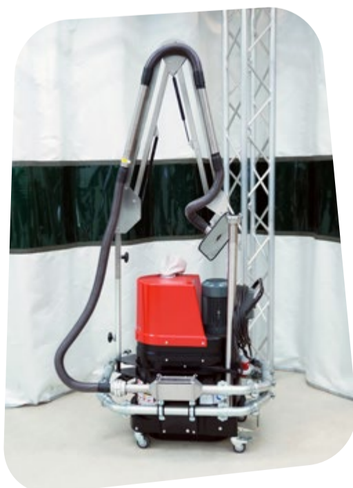
Pracoviště bylo dále vybaveno Alu+ Carbon vysavačem (CRFP), který je speciálně konstruován na odsávání špon a prachu při práci s výbušnými materiály
