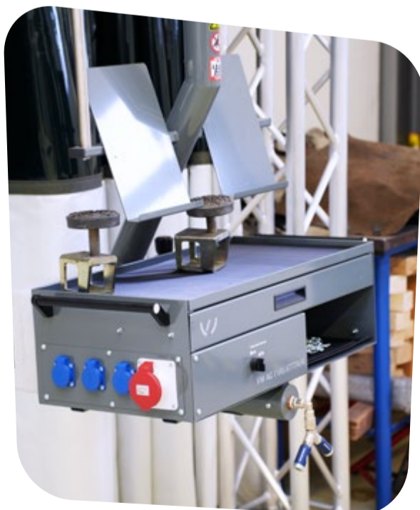
Praktickou věcí je mobilní energy box na pojezdové kolejnici. V něm jsou integrovány přípojky na 220 a 380 V, připojení na stlačený vzduch, poličku na diagnostiku a další
